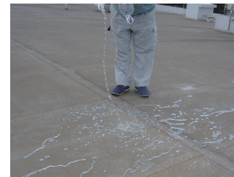
施工後11年経っても撥水性が変わらない施工現場 ※この間、塗り直しなどメンテナンスはしていない
